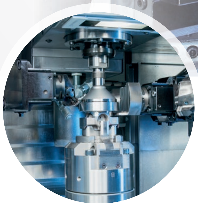
Achszapfenbearbeitung: Weichdrehen der Außenkontur
