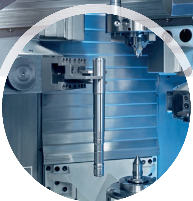
Teilewechsel: Fertigteil wird abgenommen und zur Ablage gebracht. Neues Rohteil wird zugeführt.
