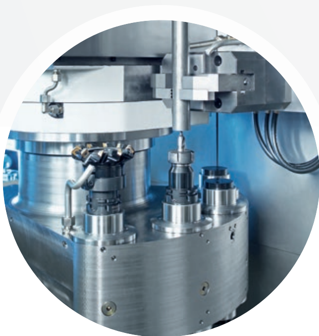
Wellenbearbeitung: Zentrieren, Bohren, Endenbearbeiten
