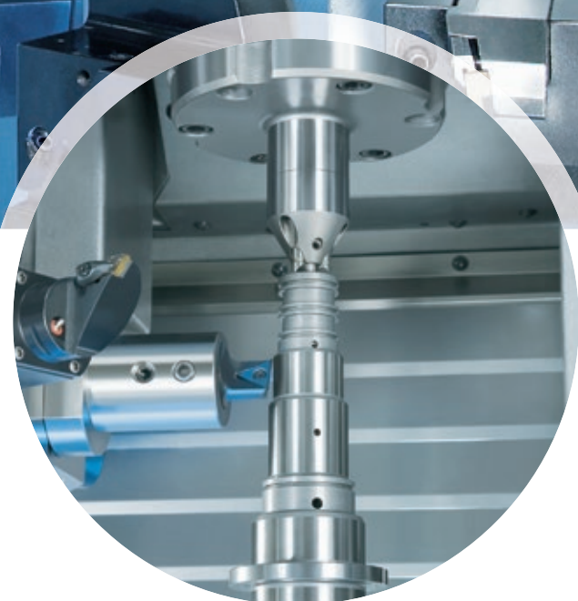
Rotorwellenbearbeitung: Drallfreies Drehen durch Skiving
