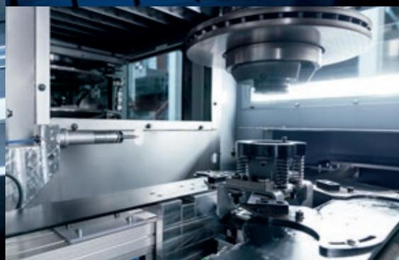
Die Bremscheiben werden durch die Aushubstation an die Hauptspindel übergeben.
