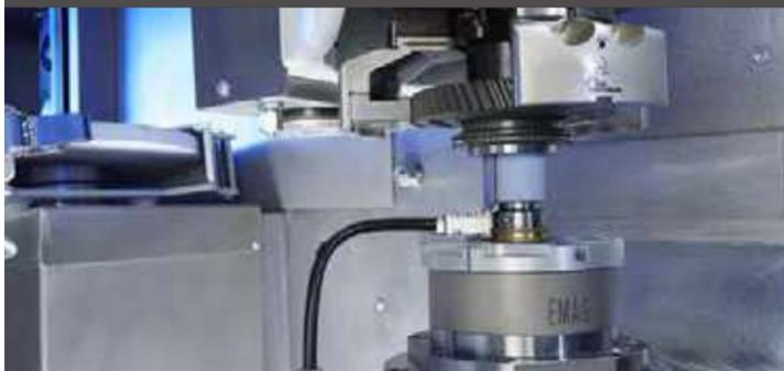
Die Bohrung und der Synchronkegel werden fertiggeschliffen. Durch den Einsatz der B-Achse ist es möglich, innenliegende Kegel mit einem zylindrischen Schleifkörper zu schleifen.
