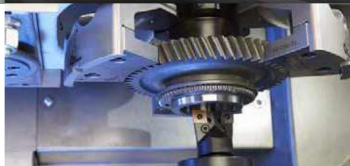
Die Planflächen werden in der Regel fertiggedreht. Bohrung und Synchronkegel werden in Abhängigkeit vom Aufmaß vorgebohrt.
