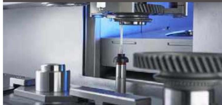
Ein Messtaster, außerhalb des Arbeitsraums und damit vor Spänen geschützt, wird zum zyklischen Zwischenmessen oder nach einem Werkzeugwechsel eingesetzt.
