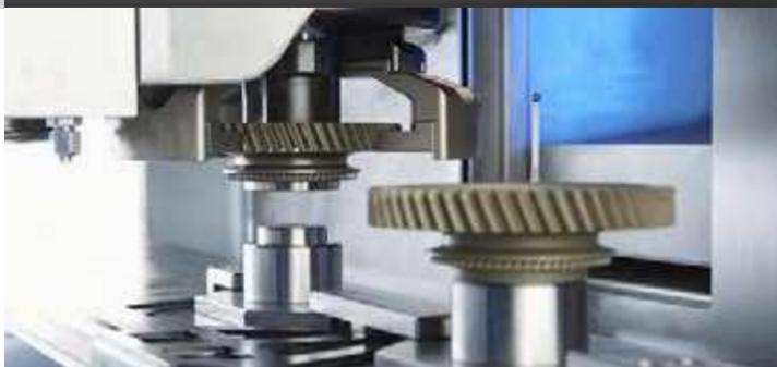
Das Be- und Entladen der Werkstücke vom Shuttle oder einem umlaufenden Band erfolgt über die Pick-up-Spindel.
