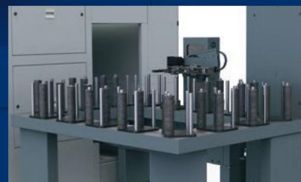
Das TrackMotion Automationssystem ermöglicht nicht nur die einfache Verkettung mehrerer Maschinen, sondern ersetzt zudem Wendeeinheiten und Transportbänder. Die Teilespeicher am Anfang und am Ende der Linie können dank ihres 3-dimensionalen Aufbaus auf Stackerpaletten viele Werkstücke speichern und garantieren so maximale Autonomie.
