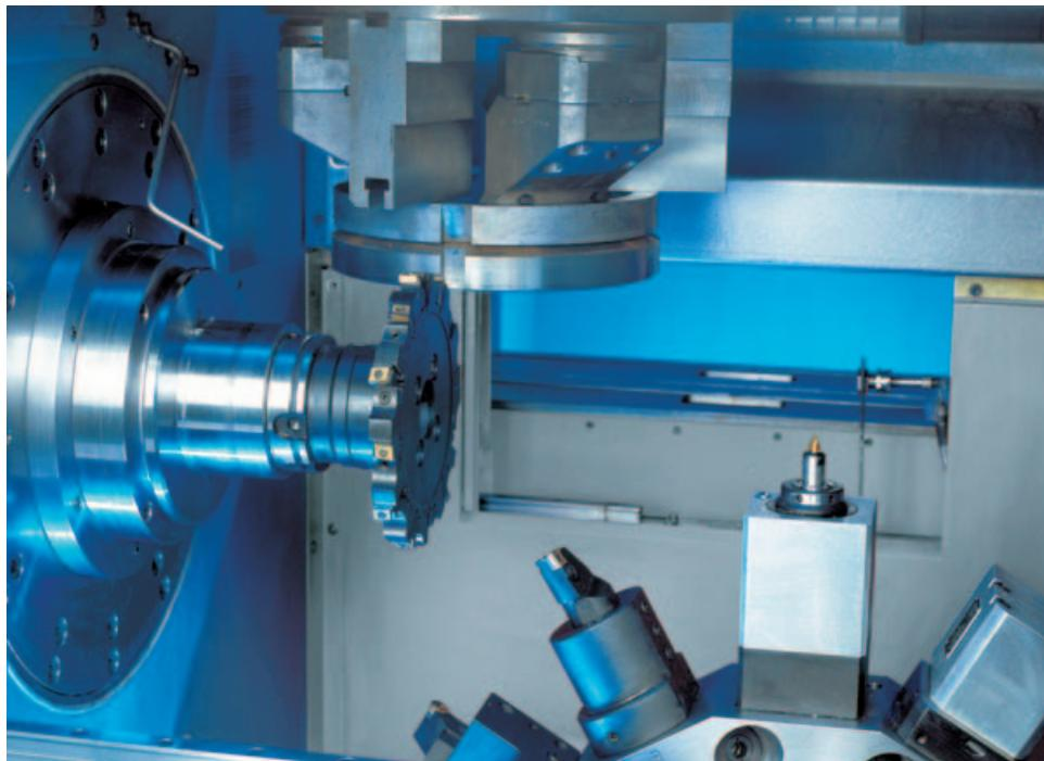
Многофункциональные станки серии VSC надежно работают в самых различных тяжелых условиях обработки: при обработке незакаленных и закаленных деталей, прерывистом резании, токарной обработке, сверлении и силовом фрезеровании
