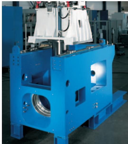
Станина с порталным суппортом станка модели VSC 400 — основа высокой производительности и качества обработки
