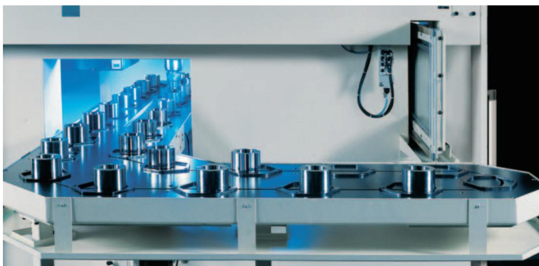
L-образная система транспортировки заготовок для отдельно стоящего станка: подвод заготовок в позицию загрузки «Pick-Up» и отвод обработанных деталей.
