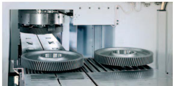
Подвод заготовок в позицию загрузки «Pick-up» для непосредственного зажима в специальном патроне
