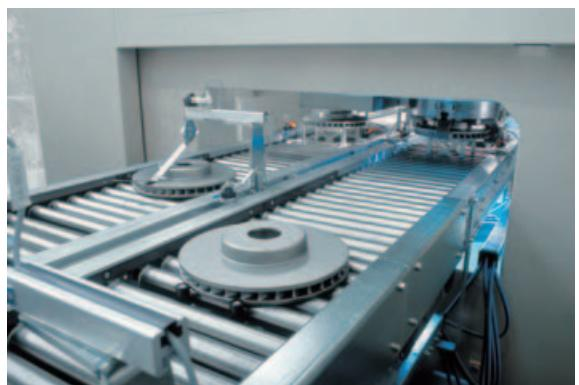
Двухпоточный транспортер для ускорения смены заготовок
