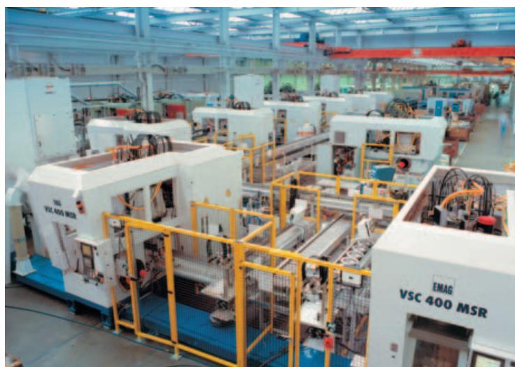
Многофункциональные обрабатывающие центры серии VSC очень часто объединяются в автоматические производственные линии, которые производят полную обработку определенной номенклатуры деталей наиболее рациональным способом. В данном примере представлены восемь станков, объединенных в автоматическую линию для обработки тормозных дисков.
