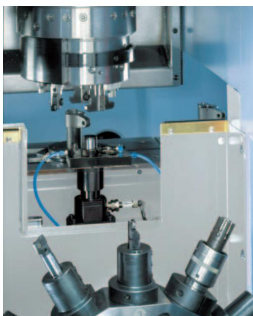
Измерение детали производится в зажатом состоянии, как при предшествовавшей обработке. При повышенных требованиях к точности, деталь после измерения возвращается в зону обработки, где она и все последующие детали после ввода необходимой коррекции на инструмент обрабатываются окончательно.
