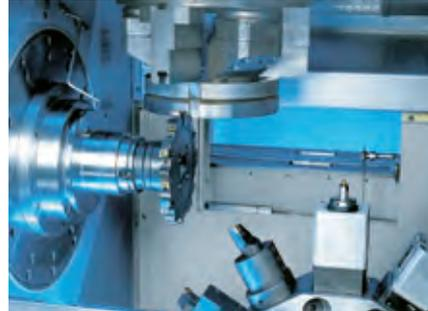
Un VSC impiegato in modo multifunzionale offre il proprio servizio anche per i lavori di dopo tempra: lavorazione tenera e dopo tempra, taglio interrotto, tornitura, foratura e fresatura.
