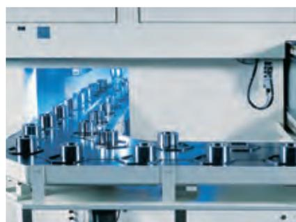
Automazione con macchine indipendenti: alimentazione dei pezzi in lavorazione verso la posizione di pick up e scarico dei pezzi lavorati
