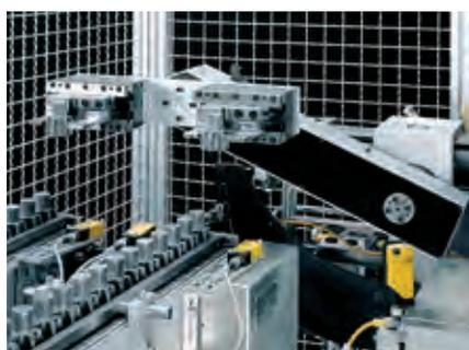
La pinza doppia preleva un pezzo da ognuno dei due nastri di alimentazione e contemporaneamente carica questi due pezzi grezzi sul nastro trasportatore.
