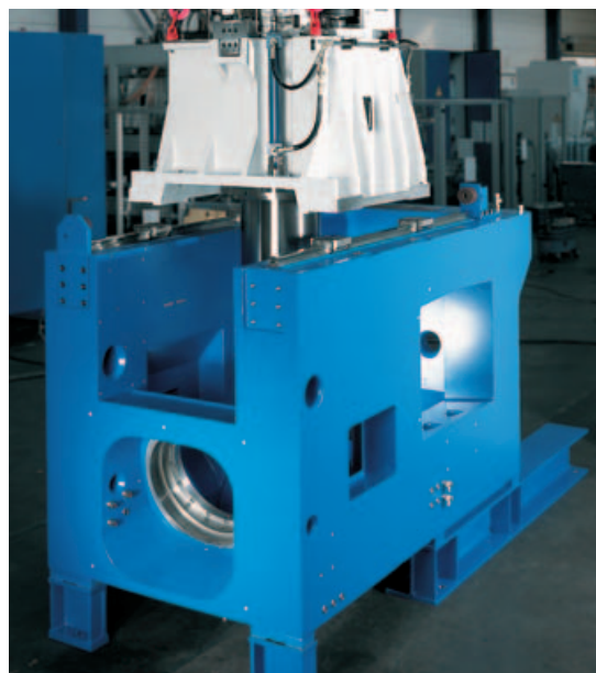
Bâti machine avec chariot portique VSC 400 - la base pour une performance et une qualité pièce élevée
