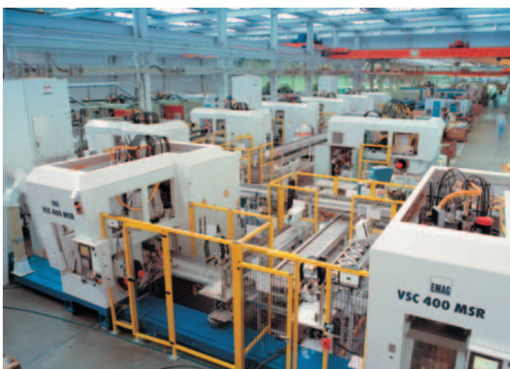
Souvent, les Centres de Production multi-fonctionnels VSC sont intégrés dans des lignes de fabrication destinées à l'usinage complet de certaines pièces. Ici un enchaînement de 8 machines pour l'usinage de disques de frein.
