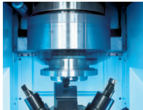
Le concept VSC : des sous-ensembles rigides, de grandes capacités d'usinage et une évacuation libre des copeaux
