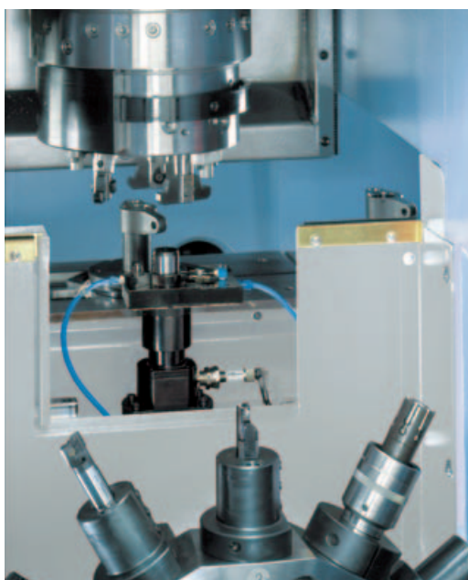
Mesure d'un alésage avec tampon de mesure (porte de protection entre tampon de mesure et zone de travail ouverte)
