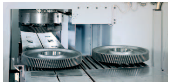
Amenée pièces à usiner vers le poste pick-up et prise en mandrin
