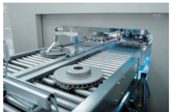
Chargement à double bande de transport pour une rapidité assurée
