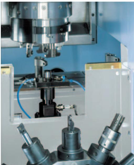
Medición de diámetro con tapón de medición
