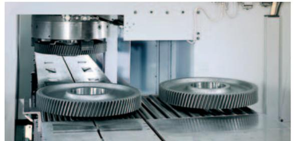
Entrada de las piezas a mecanizar hacia el puesto pick-up y carga por plato.
