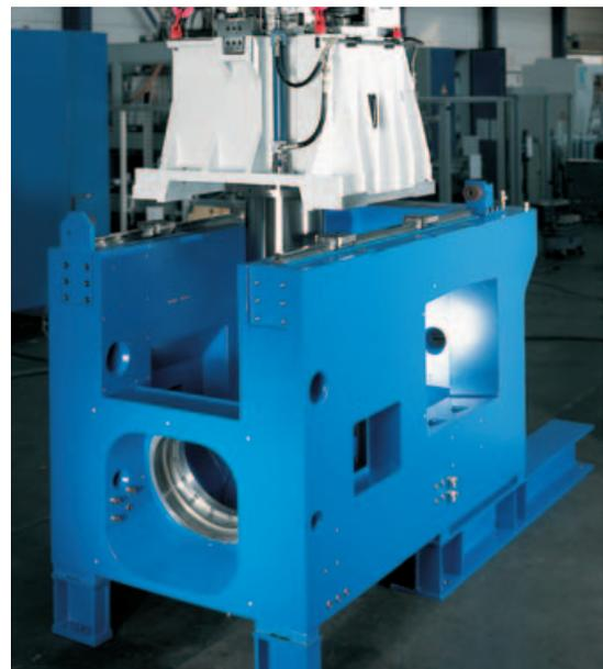
Bancada de la máquina con carro pórtico VSC 400
