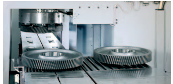
Entrada de las piezas a mecanizar hacia el puesto pick-up y carga por plato.
