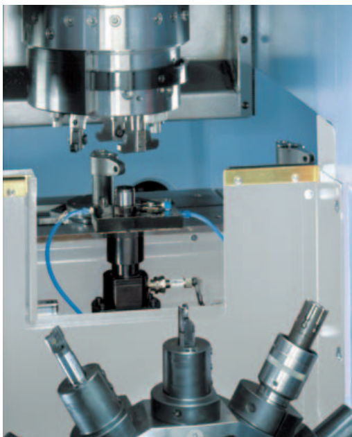
Medición de diámetro con tapón de medición (trampilla entre el tapón de medida y la zona de trabajo abierta)
