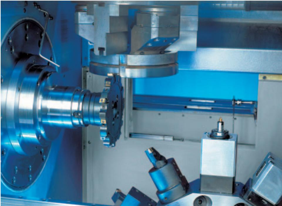
Incluso cuando se trata de mecanizados muy difíciles, la máquina VSC con su concepto multi-funcional es ideal: mecanizado en blando o en duro, corte interrumpido, torneado, taladrado y fresado de gran potencia.
