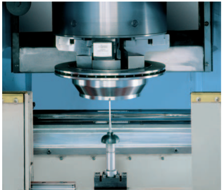
Medición de piezas con palpador. (trampilla entre palpador y zona de trabajo abierta).
