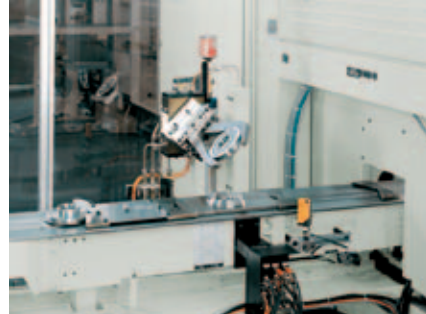
Beispiel VSC 250 DUO: Wendestation zum Wenden der Werkstücke zur anschließenden Bearbeitung der Werkstück-Rückseite in der zweiten Aufspannung
