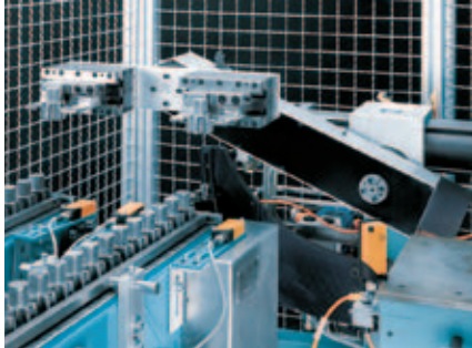
Ein Beispiel von vielen: Zwei Rohteile werden gleichzeitig dem Teilemagazin entnommen, ...
