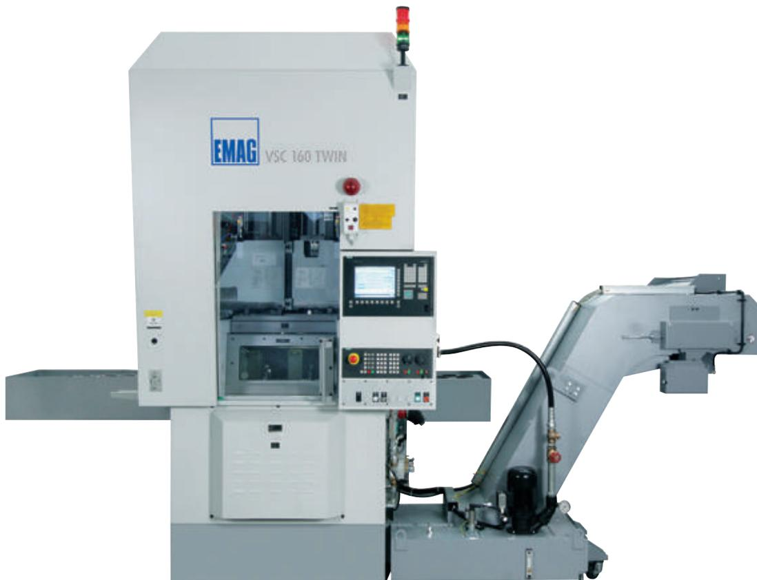
Los carros de pórtico son unidades separadas. Ambos carros y cabezales cuentan con accionamientos independientes en los ejes X y Z, así como también sistemas de medición lineal separados en todos los ejes.
