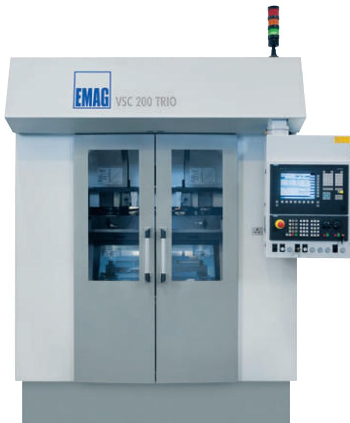
En el área de trabajo, el portaherramientas puede alojar hasta ocho herramientas por cada uno de los tres cabezales. El portaherramientas está montado sobre rodamientos de forma muy rígida en ambos lados en la bancada. Mediante un accionamiento directo de tipo servo las posiciones de herramientas se pueden conmutar muy rápido.
