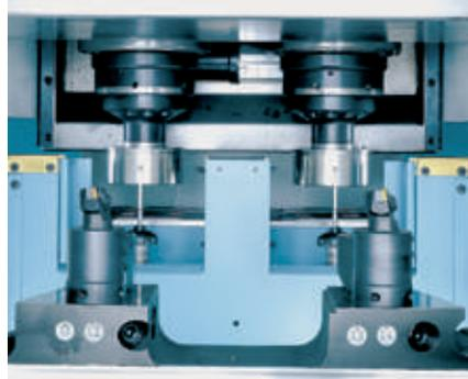
El proceso de medición ahorra tiempo midiendo dos piezas simultáneamente. Sin embargo correcciones de diámetro y longitud realizan individualmente para cada cabezal. (Puerta de protección abierta entre palpador y área de trabajo)
