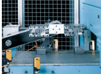
... se depositan sobre la cinta transportadora y se llevan a la posición de recogida de ambos cabezales de la VSC 160 TWIN.
