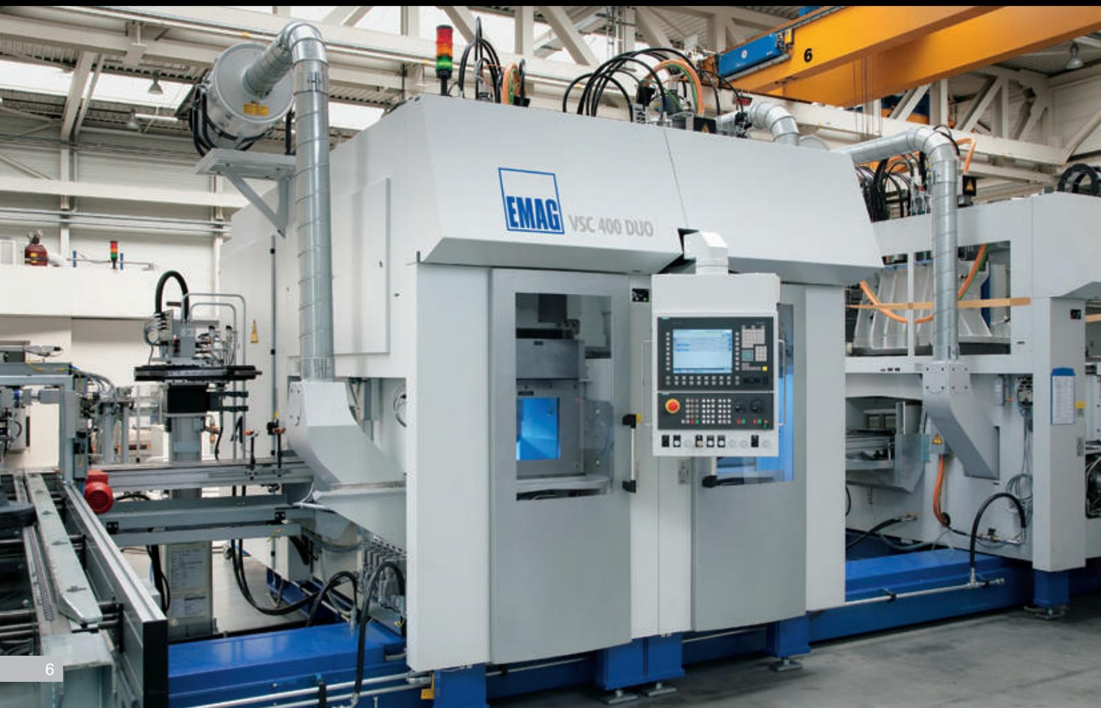
Ambos revólvers no solo pueden alojar herramientas de torneado, sino también herramientas motorizadas para el fresado y taladrado. Con ello ambos cabezales pueden efectuar tanto mecanizados idénticos como diferentes:
