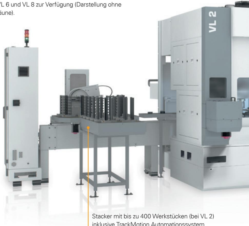
Stacker mit bis zu 400 Werkstücken (bei VL 2) inklusive TrackMotion Automationssystem
