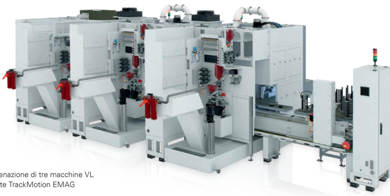
Concatenazione di tre macchine VL mediante TrackMotion EMAG
