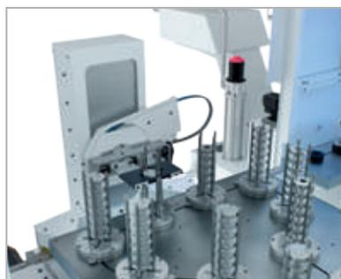
Possibilità di stoccaggio dei pezzi grezzi. Capacità di accumulo: fino a 400 pezzi (a seconda della geometria del pezzo).
