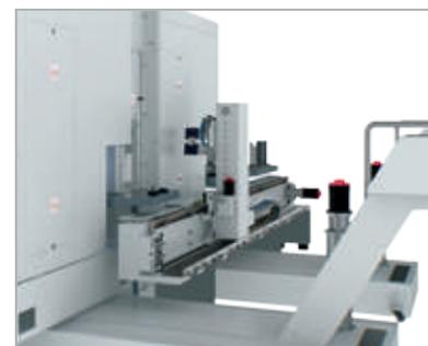
Le operazioni di ribaltamento e trasporto, su macchine concatenate, vengono effettuate mediante TrackMotion
