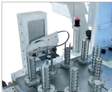
Le magasin met à disposition les pièces brutes (capacité de stockage allant jusqu'à 400 pièces selon la géométrie pièces).
