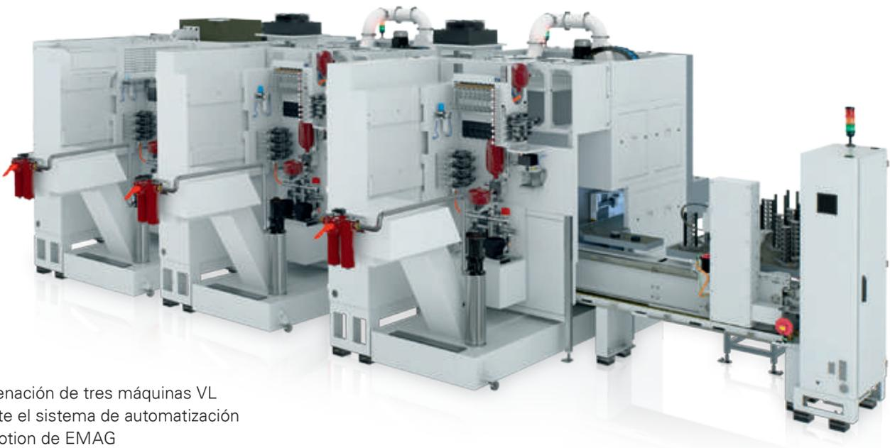
Concatenación de tres máquinas VL mediante el sistema de automatización TrackMotion de EMAG
