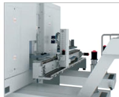
Las máquinas están concatenadas mediante el sistema de automatización TrackMotion. Tanto el posicionamiento como el volteo se lleva a cabo mediante este sistema.
