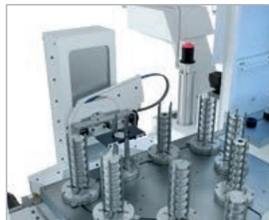
Über einen Teilespeicher werden die Rohteile zur Verfügung gestellt (Speicherkapazität bis zu 400 Teile, abhängig von der Werkstückgeometrie).
