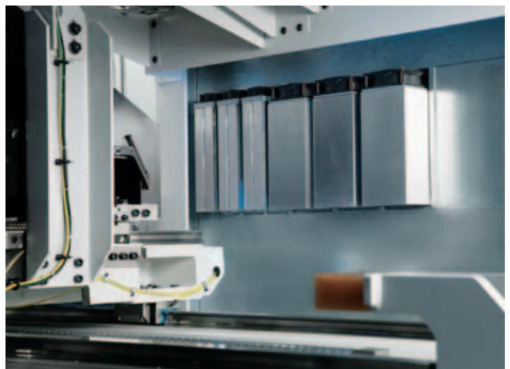
Energiesparendes Durchsteckprinzip: EMAG nutzt bei der VLC 250 die Möglichkeit, Verstärker nach hinten aus dem Schaltschrank durchzustechen und über einen einfachen Lüfter in die Halle zu kühlen. Ein Energie fressendes Klimagerät wird somit überflüssig.
