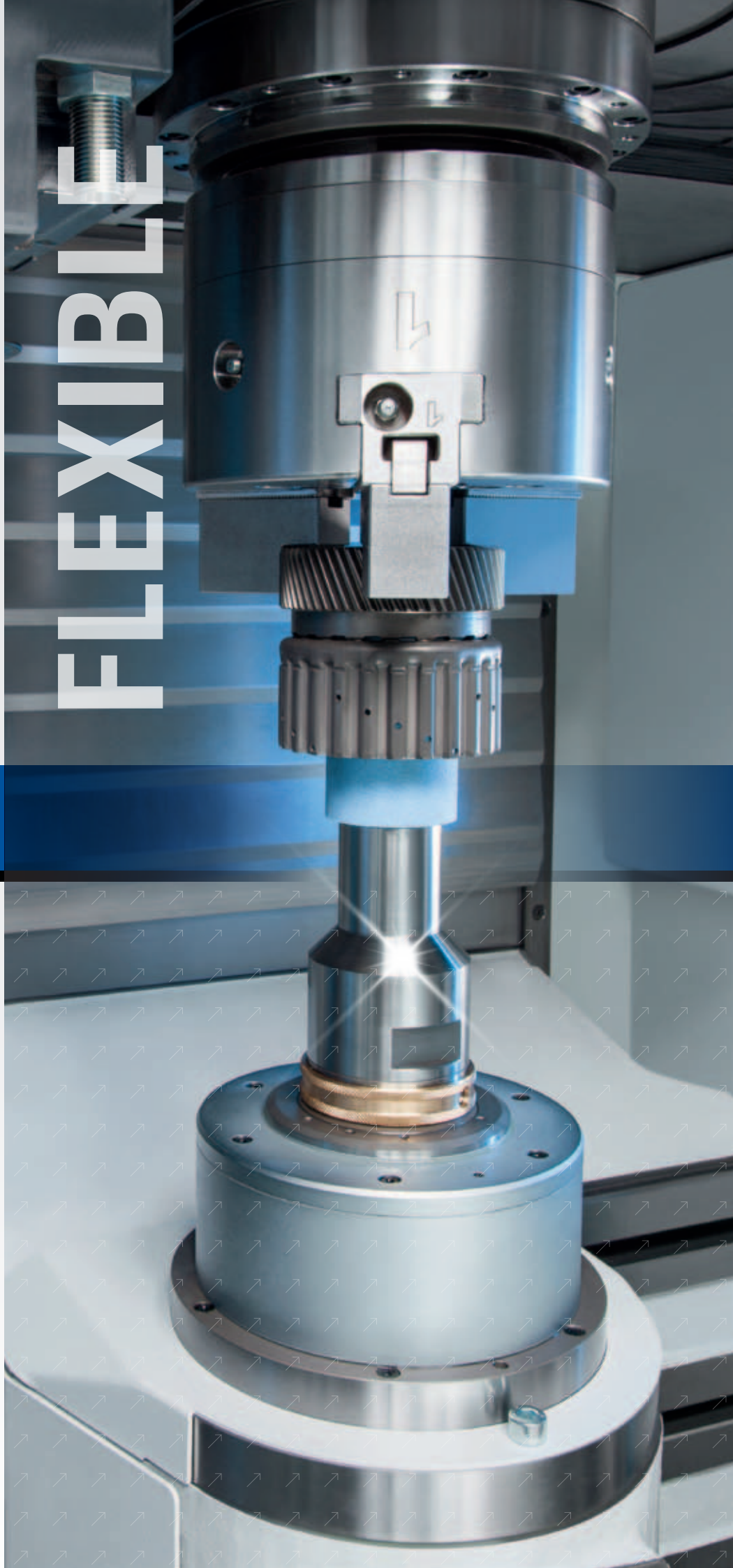
Combinaison tournage dur + rectification inté- rieure + extérieure
