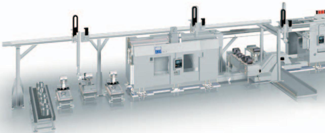
So ergibt sich eine Durchlaufzeiteinsparung von 30–50%, je nach Muffenart, Gewindeform und Bearbeitungsmaterial.
