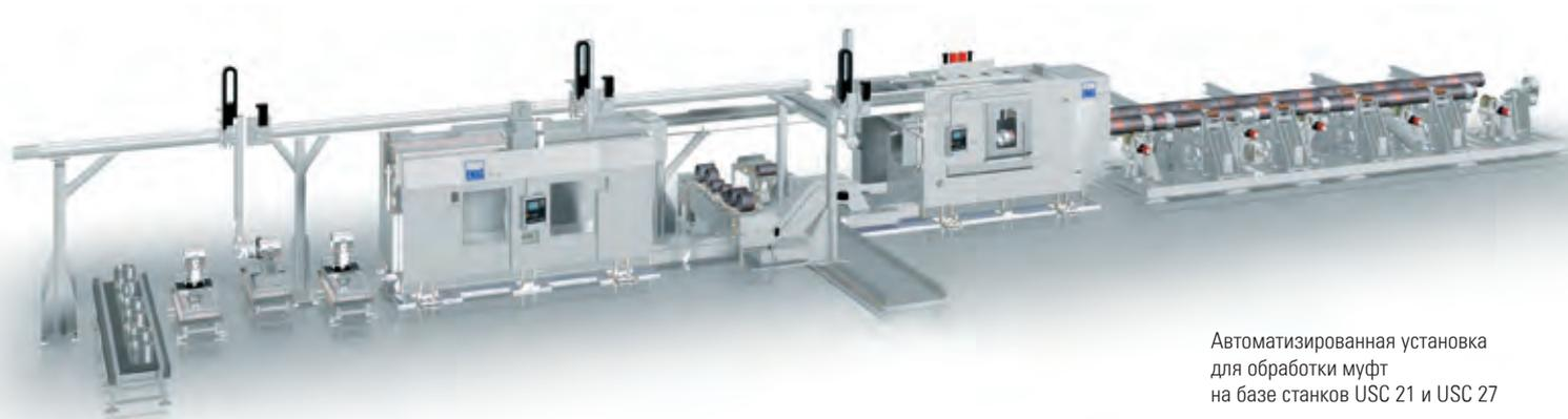
Автоматизированная установка для обработки муфт на базе станков USC 21 и USC 27
