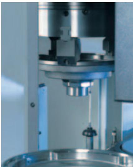
Anche la misurazione è un componente integrato nella serie VLC. Nel tragitto dal vano di lavoro alla posizione di deposito, il pezzo viene misurato dal tastatore all'esterno della zona di lavoro. I risultati di misurazione non vengono influenzati in alcun modo, nè dai trucioli, nè dallo sporco.
