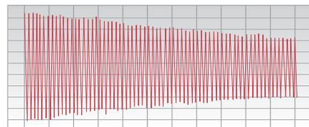
Zum Vergleich: Schwingungsdämpfung an Maschinenbetten aus Grauguss
