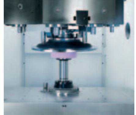
realisieren. Des Weiteren bietet die Maschine die Möglichkeit, hohe Oberflächengüten und enge Toleranzen (präzise Bohrungen) über die direkt angetriebene Spindel prozesssicherer zu bearbeiten. Um die VLC 1200 im flexiblen Werkstatteinsatz voll nutzen zu können, bietet EMAG einen Werkzeugwechsler mit Kettenmagazin.
