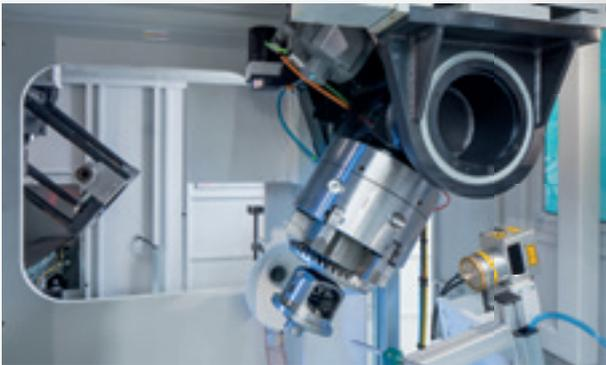
Die schwenkbaren Spindeln ermöglichen sowohl axiale als auch radiale Schweißprozesse
