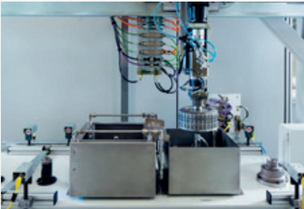
Bei der Messung mit Ultraschall durchläuft ein Ultraschallimpuls das zu prüfende Werkstück. Die für den geprüften Werkstoff bekannte Schallgeschwindigkeit bzw. die Abweichung von dieser bei den empfangenen Signalen ermöglicht Rückschlüsse auf mögliche Fehler im Material wie z.B. Risse oder Einschlüsse.
