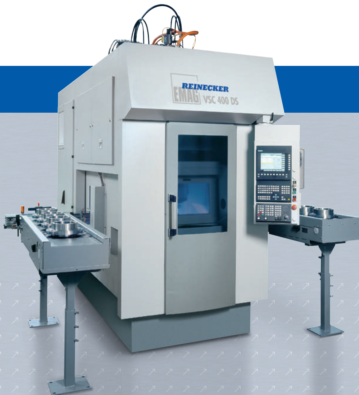
Torretta revolver con 12 posizioni per utensili di tornitura ed un mandrino fisso per rettificazione fori.
