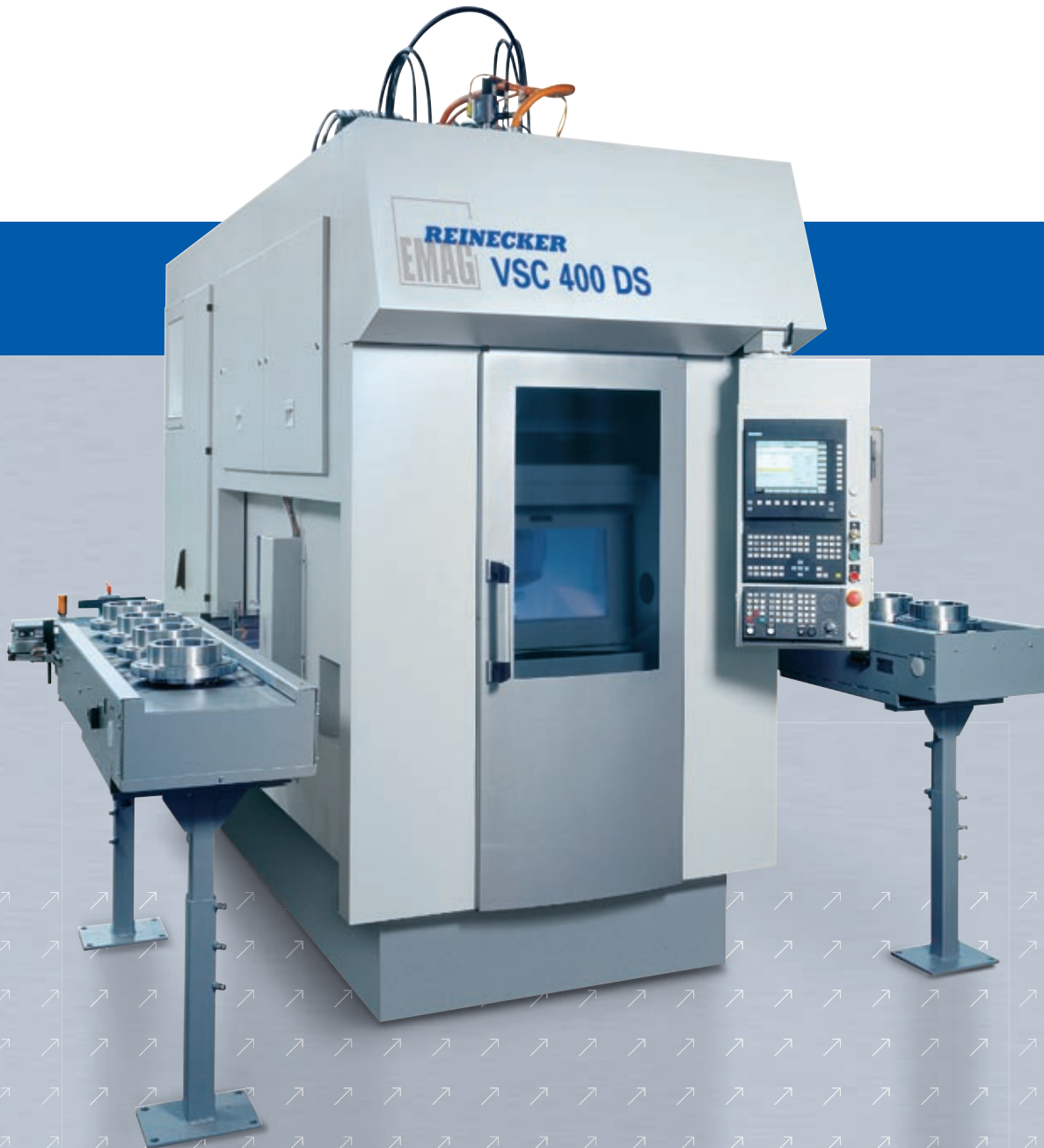
Tourelle revolver pour 12 outils tournants + une broche porte-meule fixe pour la rectification d'alésages.
