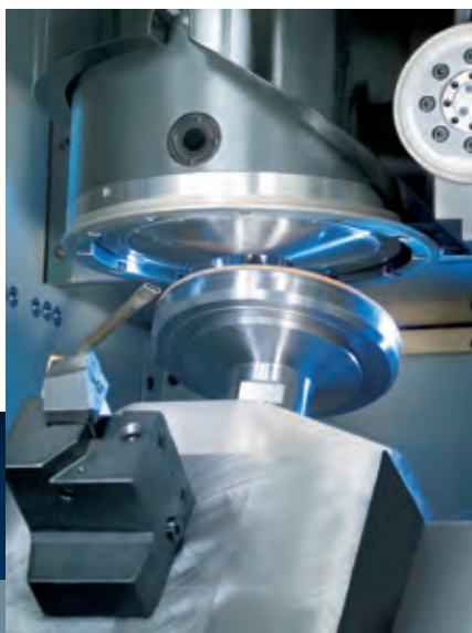
采用CBN砂轮进行精密磨削
