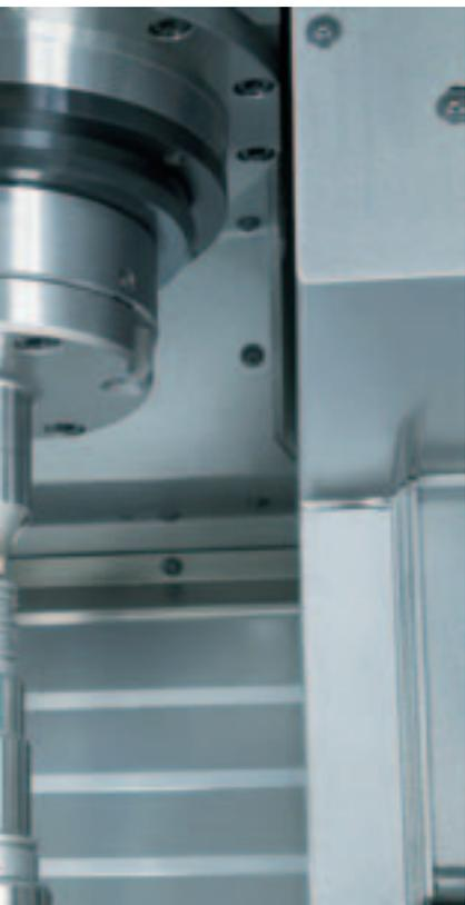
Automazione integrata: attraverso una pinza nella torretta revolver, la macchina VTC 315 DS si carica da sola
