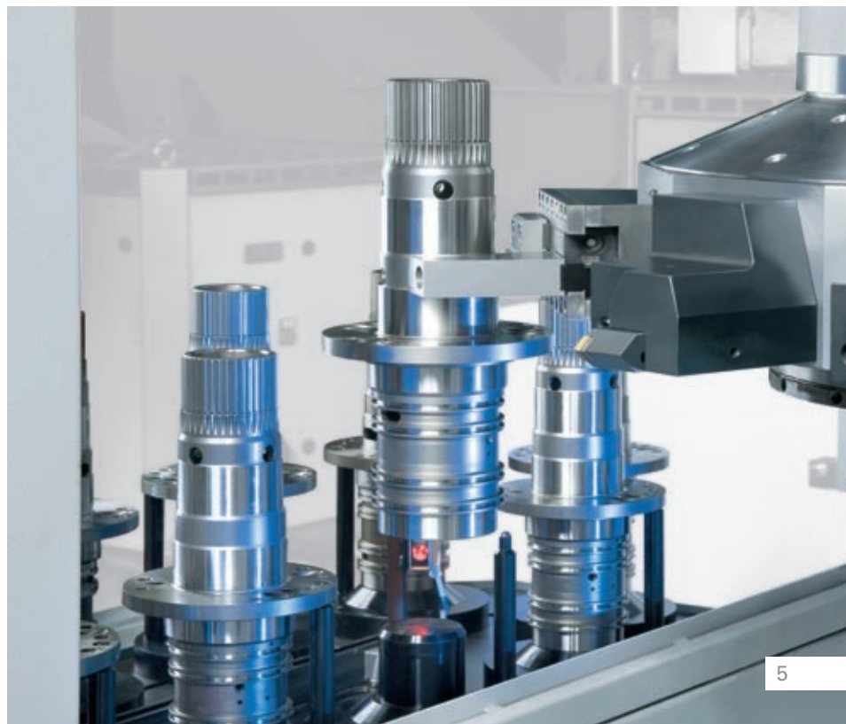
Automatisation intégrée. La machine VTC 315DS se charge toute seule avec la pince de préhension.
