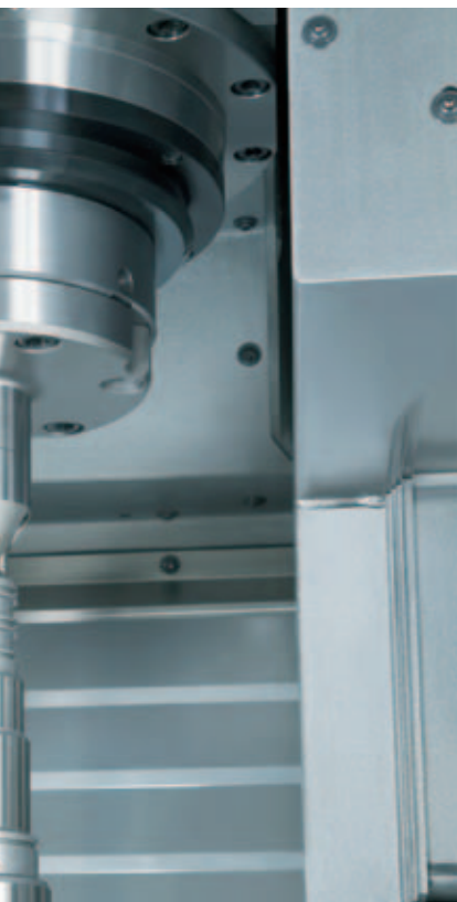
Schäldrehen durch Schwenken des Revolvers
