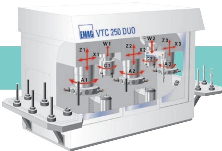
*Chargement pièces : Prélèvement de la pièce finie et transfert vers la dépose. Amenée d'un nouveau brut (de gauche vers la droite)*
