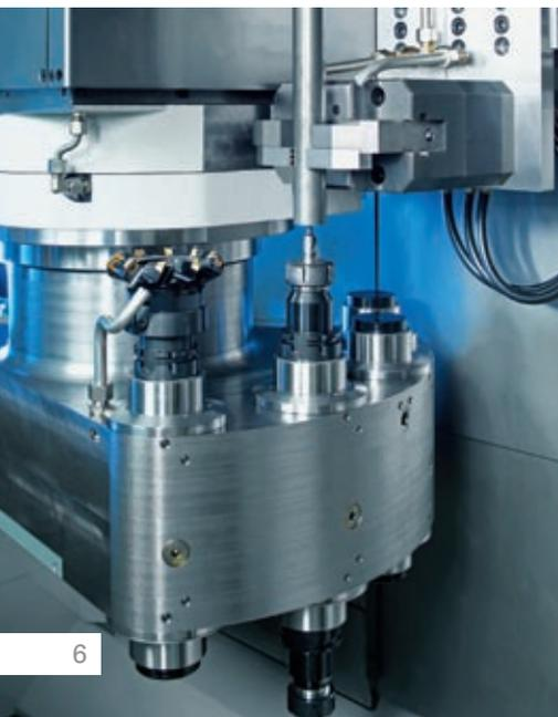
*Usinage de pistons en acier :
