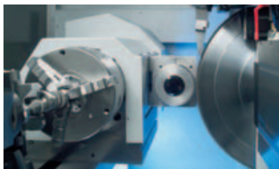
Ravvivatura di un disco di rettifica in CBN a legante ceramico con ruota in diamante a trascinamento
