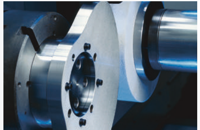
Schleifen einer Radialkurve für Textilmaschinen
