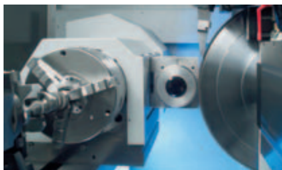
动力驱动的金刚石修整轮正在修整陶瓷粘结的CBN-砂轮
