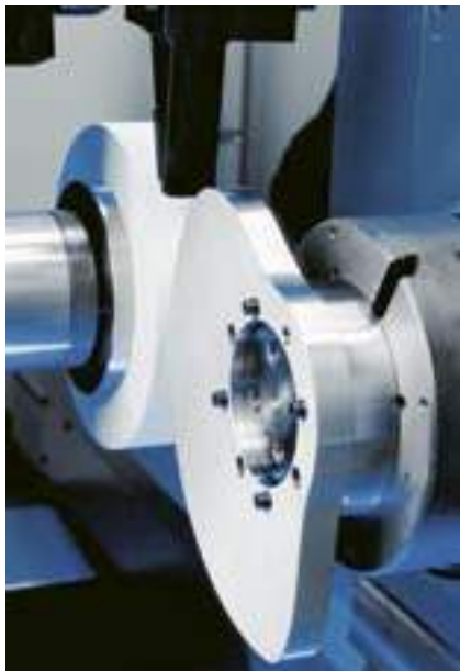
SK 204 磨床的加工区域 磨削径向凸轮
