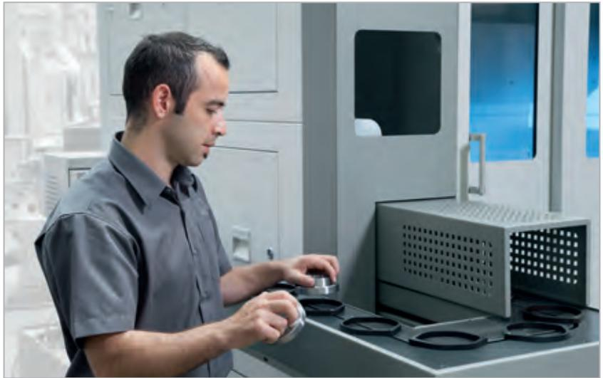
L'automazione integrata con nastro ad anello semplifica il carico e lo scarico della macchina.
