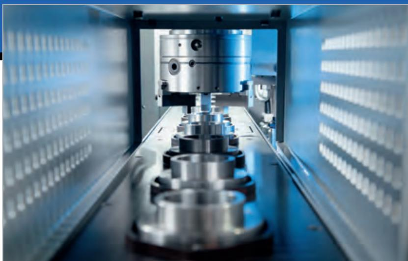
Le centrage des pièces venant de la bande de transport dans le poste pick-up est assuré par le programme CN. Les erreurs de serrage sont ainsi supprimées.
