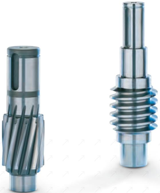
机型K 200可进行圆柱齿轮和蜗杆的软质预铣削，并可在同一台机床上使用刮削滚刀(在淬火之后)进行硬质精加工，或者甚至对于已经整体淬火的毛坯件(硬度最大至54 HRC)直接进行硬滚加工。
