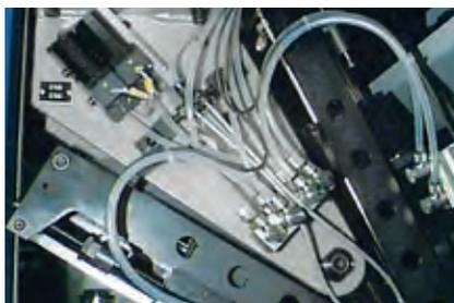
结构紧凑简单的上下料装置附带有柔性工件存储库、输送链条以及传输带。
