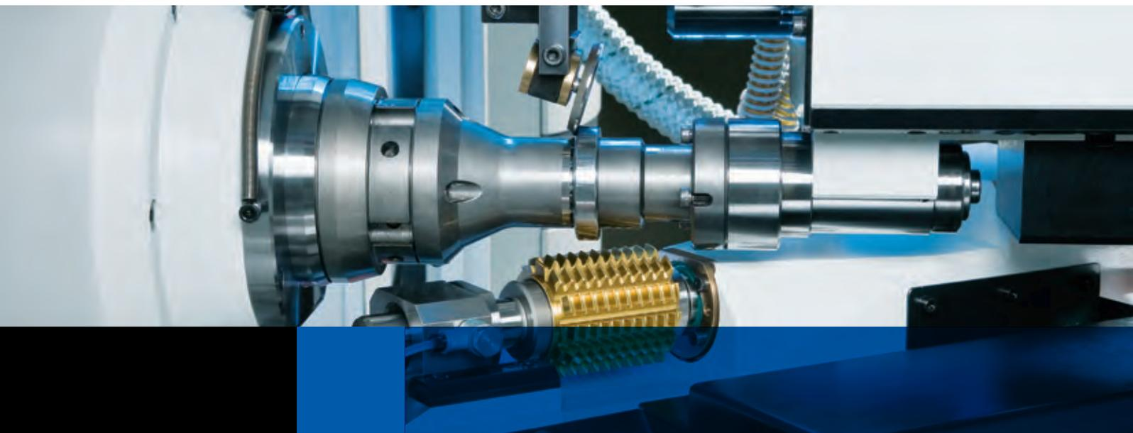
本 K200机型将创新的设计理念与最新的制造工艺相结合，并凝聚了好几代人在齿轮加工技术领域获得的宝贵经验。作为一个最低附带有8个活动CNC轴的全自动机床，滚齿机K200型几乎可以解决所有可以想象到的切齿任务。
