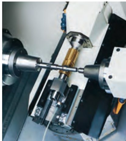
Рабочая зона с фрезерной головкой (прямой привод).
