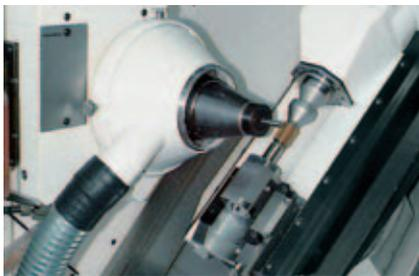
Possibilité de taillage de dentures par fraisage tangentiel de vis hélicoïdales en alternative au fraisage radial fréquemment pratiqué. Le serrage de la fraise à queue s'effectue dans le mandrin hydraulique expansible.
