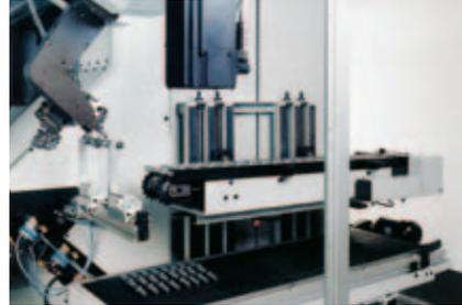
Integriertes Ladeportal mit flexiblen Werkstückmagazinen, Zuführkette und Bandablage
