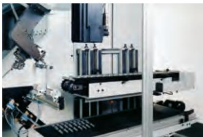
集成在机床内的高架机械手，带工件库、链式进料道和工件储存带
