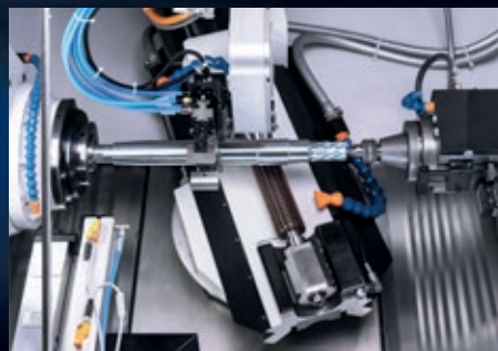
K 160 可加工直齿和斜齿轮、小齿轮或轴。
