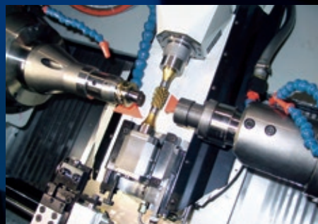
蜗轮不仅可以采用径向铣削工艺进行加工,还可以采用切向铣削工艺进行高精度加工。整体柄式滚刀通过液压涨套进行夹紧。
