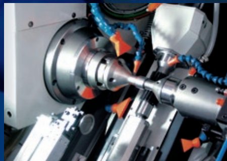
K 160 可加工直齿和斜齿轮、小齿轮或轴。
