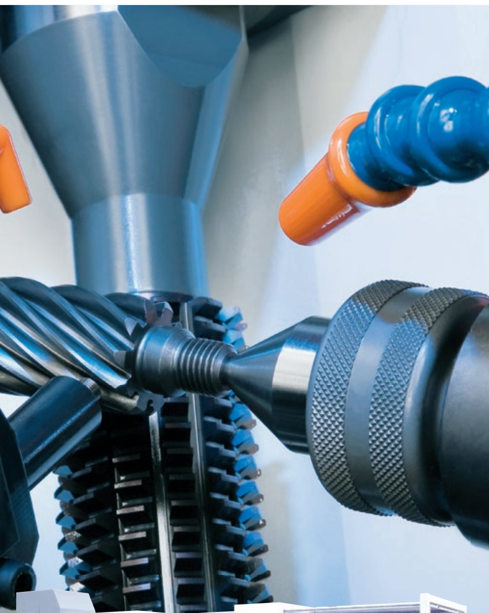
行星齿轮的干式高速滚齿
