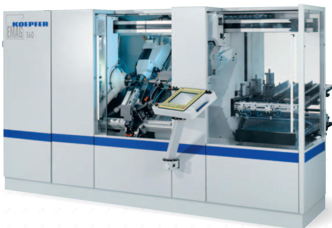
Dentatura a creatore a secco ad alta velocità di ruote dentate satelliti
