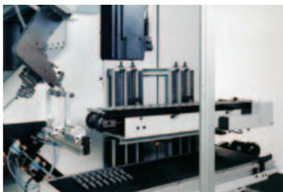
Portale di carico integrato con magazzino pezzi flessibile, catena di alimentazione e nastro di scorrimento
