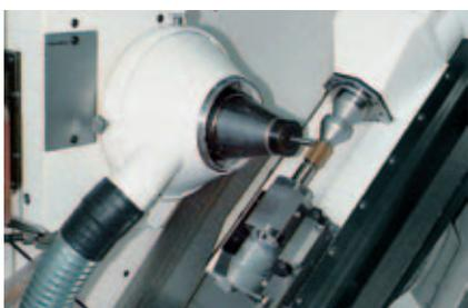
Le ruote a vite senza fine possono essere dentate non solo con procedimento di fresatura radiale, ma anche con procedimento tangenziale. Il serraggio della fresa con gambo si effettua con mandrino idraulico ad espansione.
