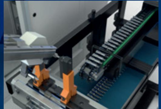
Für die Automation steht ein Hochgeschwindigkeits-Ladeportal mit Doppel-Rotationsgreifer oder ein Lineargreifer in V-Anordnung zur Verfügung.
