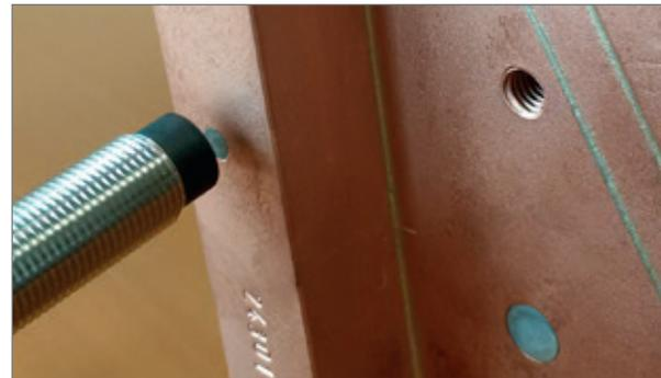
Der RFID-Chip im Werkzeug wird von einer Schreib-Lese-Einheit mit allen relevanten Daten beschrieben. Damit wird vor dem Produktionsstart geprüft, ob der richtige Induktor für das vorgewählte Bearbeitungsprogramm eingesetzt ist und welchen Zustand er hat.
