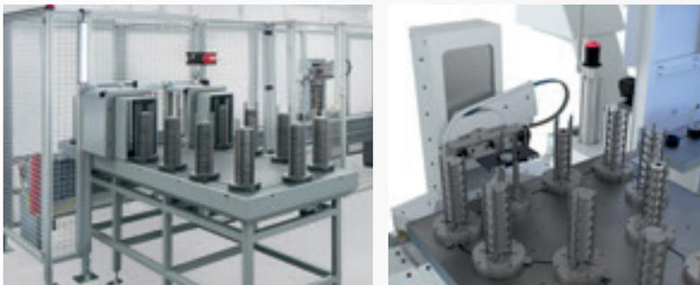
Über einen Teilespeicher werden die Rohteile zur Verfügung gestellt. Dieser bietet eine Speicherkapazität von bis zu 400 Teilen, abhängig von der Werkstückgeometrie.
