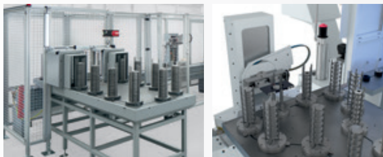
通过零件存储器提供毛坯件。 其存储容量为最多400个零件,取决于工件几何形状。
