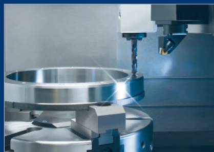
Auch Bohr- und Fräsoperationen können über angetriebene Werkzeuge im Revolver durchgeführt werden.
